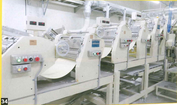
33,34 圧延ロール機のロールを1台増やし計8台に。これにより、0.4mmのワンタン皮も生成できるようになった／35 打ち粉散布機。でんぶんを均一に散布し、緑色のブラシでならす／36 折り畳み打ち抜き機。生地を重ね、丸型に抜く
