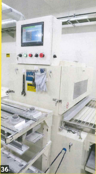
33,34 圧延ロール機のロールを1台増やし計8台に。これにより、0.4mmのワンタン皮も生成できるようになった／35 打ち粉散布機。でんぶんを均一に散布し、緑色のブラシでならす／36 折り畳み打ち抜き機。生地を重ね、丸型に抜く
